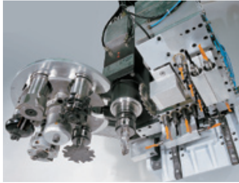
Die Werkzeugbestückung der Optimat BHC 250 mit Scheibenwechsler und Mehrspindelkopf
