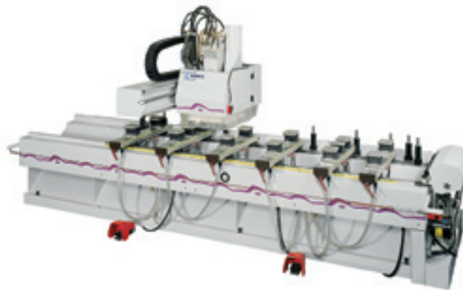
Das CNC-Bearbeitungszentrum Optimat BHC 250 für das Handwerk
