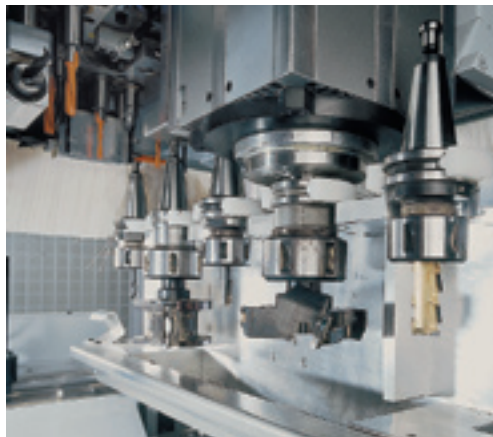
Im zusätzlichen Pick-up-Magazin stehen weitere Werkzeuge zur Verfügung
