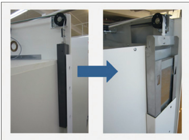
Bild 10: Schiebefensterpositionierung: Alte und neue Lösung im Vergleich
